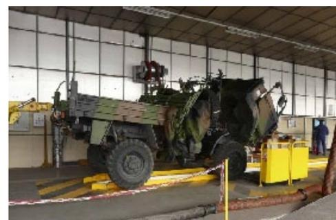
Passage au banc de freinage du TRM 2000 remis partiellement en état.
